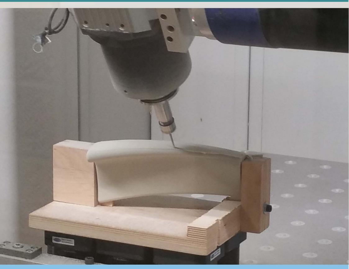
Bild links: Schlichtvorgang der Sitzschalen-Formatierung Bild rechts: Probefräsen der Armlehne
